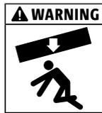
**⚠ WARNING** Peligro por la caída de elementos de construcción en caso de falta del soporte! El balcón debe estar siempre apoyado por dimensionamiento estático. Retirar soportes temporales solo después de instalar el soporte definitivo.
