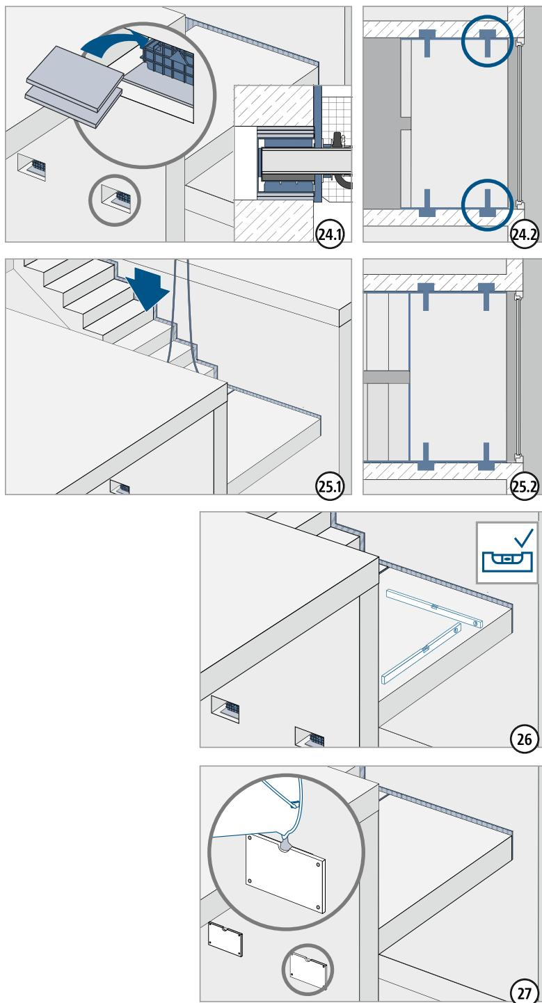
Utilisation de **plaques de compensation** résistantes à la pression (par ex. acier, dimensions minimales 180 × 120 mm) en haut sur l'élément mural Tronsole® type P part W protégeant du relevage du palier.
