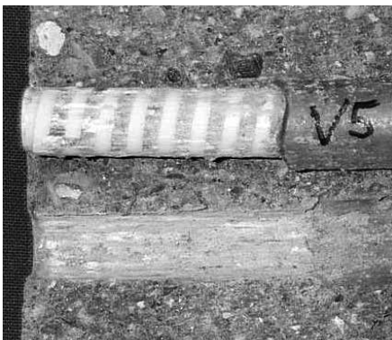
Le profil de surface particulier des barres Schöck Combar® assure une adhérence optimale entre le béton et l'armature.
